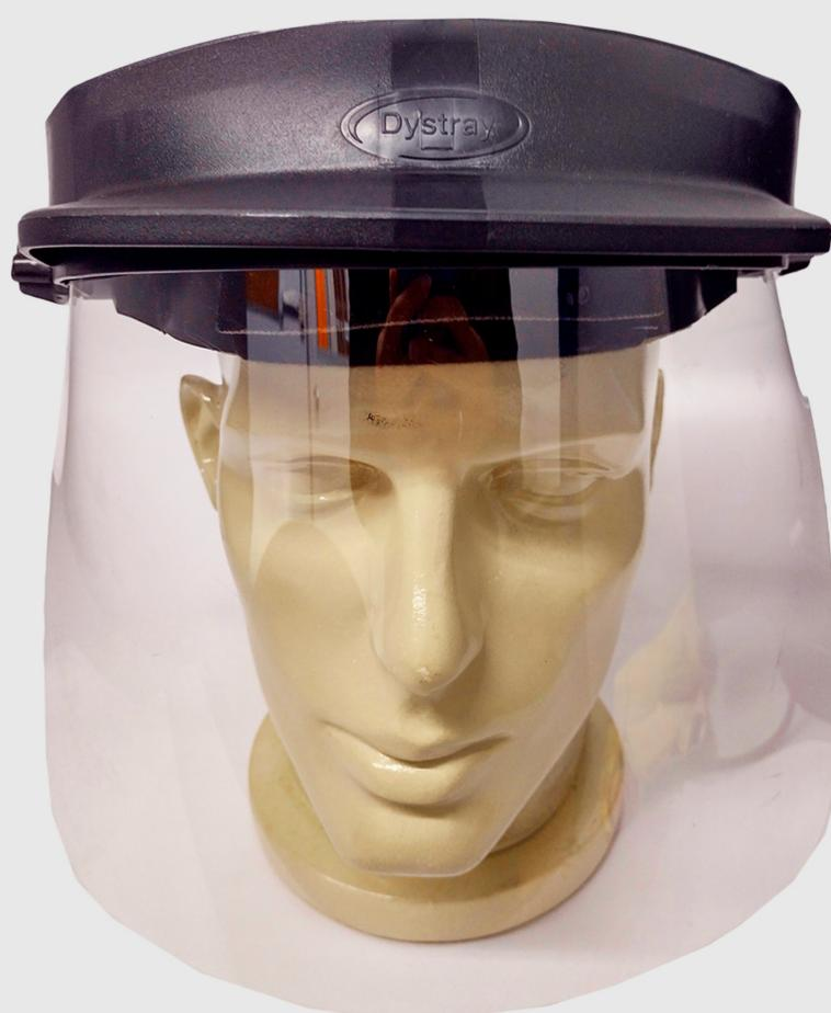
**Descrição:** Protetor Facial com viseira em policarbonato incolor de 300mm de largura, disponível no tamanho de aproximadamente 8". Carneira regulável através de ajuste simples ou por catraca, a parte frontal da carneira é coberta com espuma para absorção de suor. Produto isento de partes metálicas. Testado e aprovado dentro dos padrões internacionais de qualidade e da norma ANSI/ISEA Z87.1-2015.
