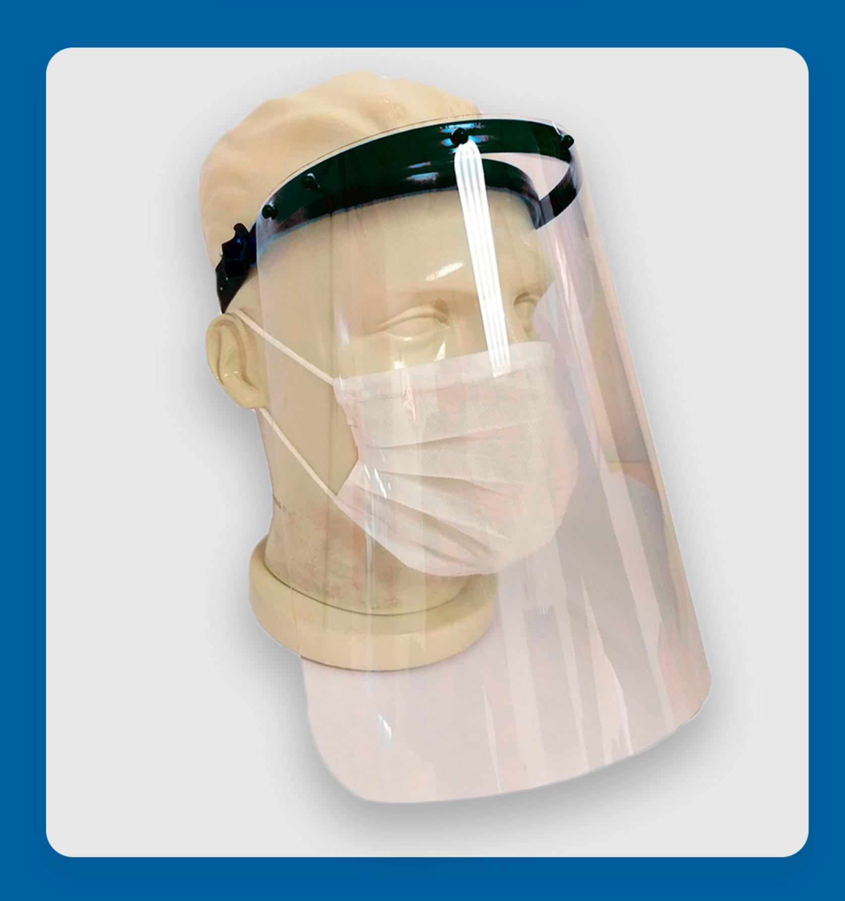
Descrição: Face Shield com testeira em PEAD, viseira de PETG transparente com espessura de 0.5 mm e área do visor de 270x245 mm que cobre toda área da face e parte do pescoço, também contém um elástico regulável com 20mm de largura, isento de partes metálicas e tira o suor para conforto do usuário, dentro das especificações da **ANVISA RDC 356 de 23.03.2020.**
